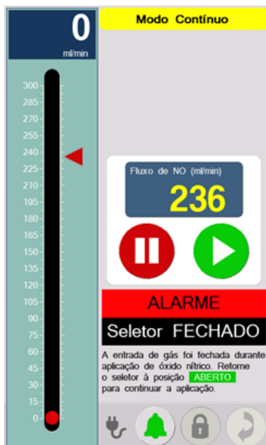
Alarme "Seletor Fechado" em Modo Contínuo
