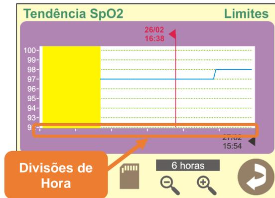
No gráfico, marcações indicam intervalos de 1 hora no eixo das abscissas (Eixo X), como mostra a figura ao lado (6 horas – 6 divisões).
