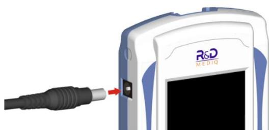
A conexão da fonte de alimentação externa deve ser feita como mostrado na figura ao lado, sempre segurando o conector pelo corpo ao ligar e desligar a fonte.
