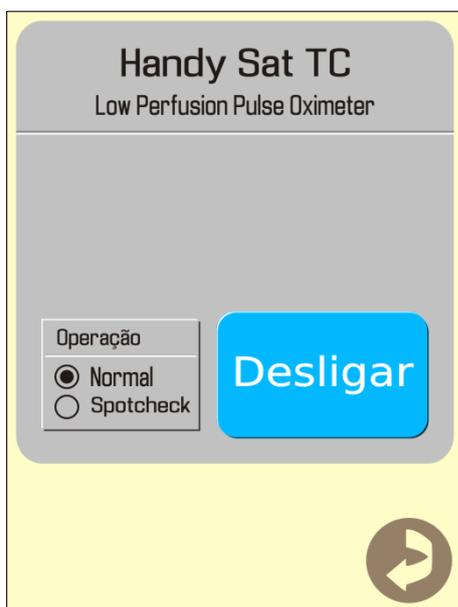
A alteração do modo de operação é realizada na “**Tela Desligando o Equipamento**”, para abrir esta tela, pressione o botão Liga/Desliga do equipamento por 2 segundos, então a “**Tela Desligando o Equipamento**” será exibida, como mostra a figura ao lado.
