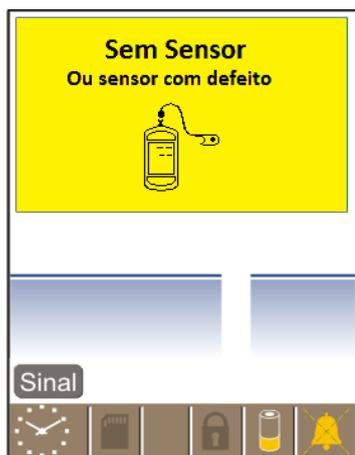
Quando o sensor está desconectado do oxímetro, o equipamento informa através da mensagem **SEM SENSOR**, conforme mostrado ao lado.
