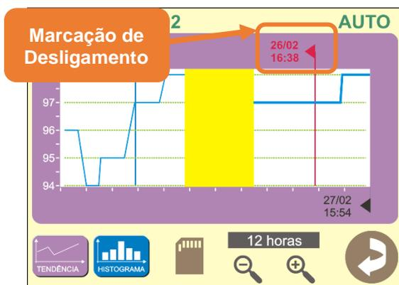
Caso o equipamento seja desligado, será acrescentada ao gráfico de tendência uma **Marcação de Desligamento**, apresentando a data e a hora na qual o equipamento foi desligado, como mostra a figura ao lado. Esta marcação deve ser utilizada como referência para os pontos posteriores a ela (à direita da marcação).
