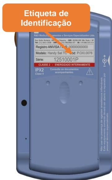
**Etiqueta de Identificação:** Identifica o fabricante, o modelo, o número de série e a classe do equipamento.
