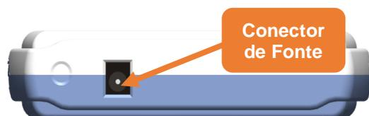
**Conector de Fonte:** Utilizado para conexão da fonte externa de alimentação ou para conexão ao Dock Station.
