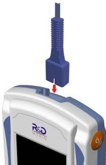
O conector do cabo do sensor de oximetria é do tipo DB9. Ele deve sempre ser inserido ou retirado segurando-se pelo corpo. Jamais gire ou puxe pelo cabo, sob pena de danificá-lo irremediavelmente.
