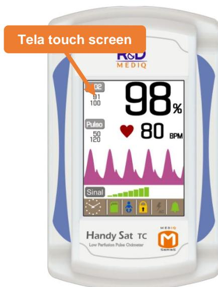
**Tela Touch Screen:** A tela touch screen é responsável por toda a interface com o operador, apresentando todas as informações relativas à monitorização, situações de alarmes, ajustes, etc e possibilitando que o operador realize todas as interações necessárias com o oxímetro.
