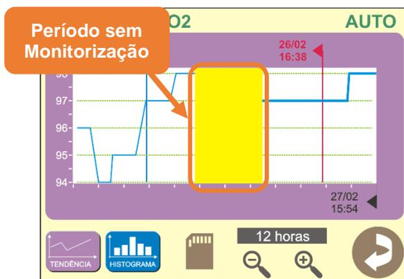
Quando não há monitorização, devido, por exemplo, ao acionamento de um alarme, a área do gráfico é apresentada em amarelo e a curva do gráfico de tendência não é plotada. Como mostra a figura ao lado.
