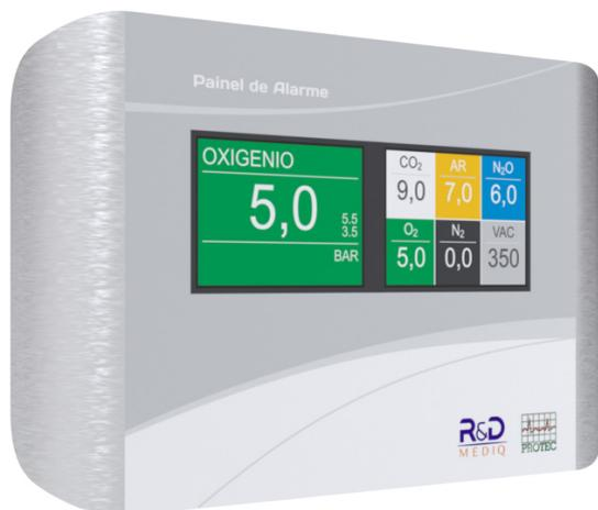
O painel de alarme digital monitora a pressão de uma rede canalizada de gás medicinal e indica, por meio de alarmes audiovisuais, a queda desta pressão para valores abaixo de seus limites.
